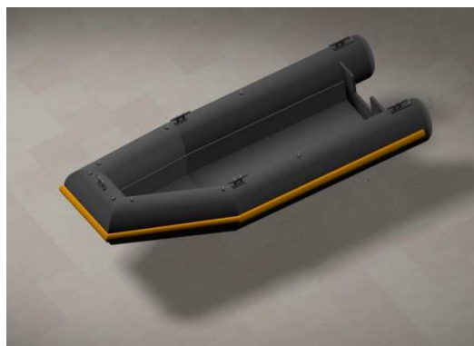
Rys. 1: Projekt jednostki w całości wykonanej z polietylenu (WORKER – długość 4m).
