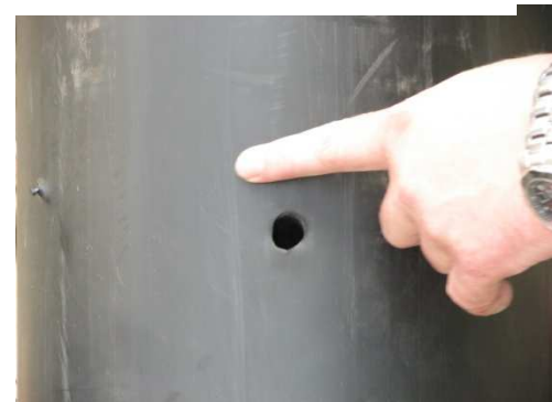
Rys. 6: Próby strzeleckie pływaków wypełnionych pianką PP.
