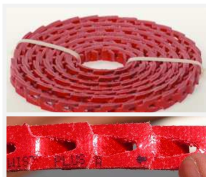
Rys. 6. Przykładowy uniwersalny pasek klinowy. W zależności od potrzeb odmierza się potrzebną długość paska łącząc go na zasadzie rybiej łuski. Źródło: archiwum T. Smoła.
