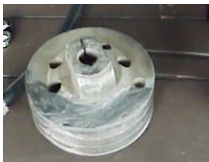
Rys. 7. Koło pasowe samochodu Tarpan Honker, zregenerowane kompozytem klejowym. Źródło: archiwum T. Smoła.
