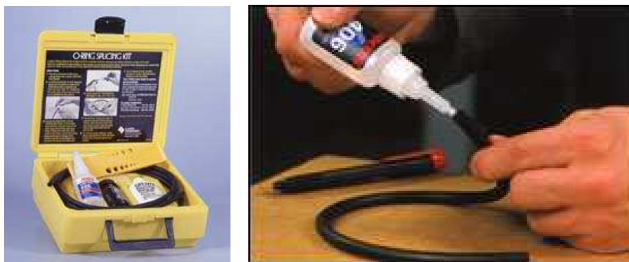
Rys. 8. Przykład uniwersalnego oringu. W zależności od potrzeb dobiera się odpowiednią długość waleczka elastomerowego i odwzorowując zużytą część, łączy się nowy ring klejem kontaktowym.
