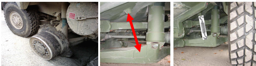
Rys. 15. Miejsca mocowania śruby rzymskiej blokującej zawieszenie w górnym położeniu (wniosek racjonalizatorski T. Smoła). Źródło: archiwum T. Smoła.
