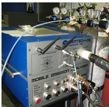
Rys. 4. Widok analizatora spalin (a) i sondy do pomiaru masowego natężenia przepływu spalin (b)
