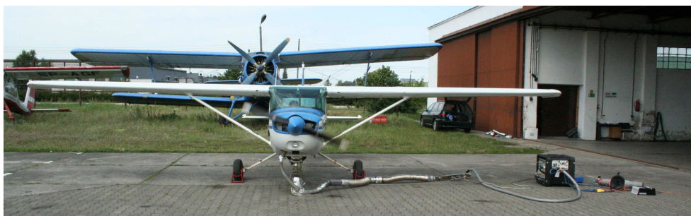
Rys. 3. Sposób zamocowania sondy poboru spalin
