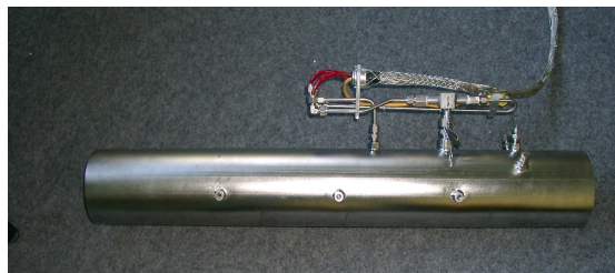
Rys. 4. Widok analizatora spalin (a) i sondy do pomiaru masowego natężenia przepływu spalin (b)
