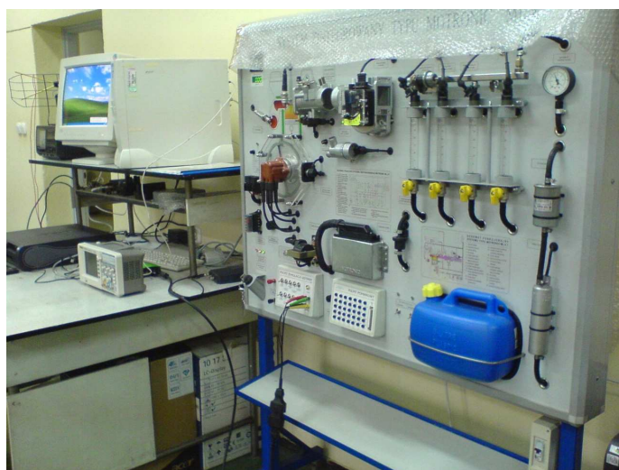
Rys. 4. Stanowisko laboratoryjne Motronic do badania sieci informacyjnych (wewnętrznych)
