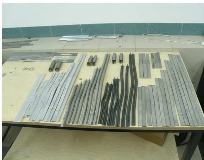
Rys. 1. Pręty metalowe o różnych przekrojach poprzecznych przeznaczone do badań
