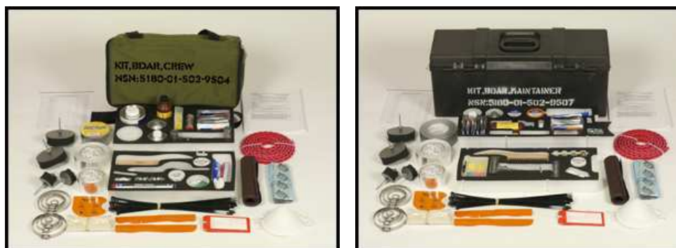
Rys. 11. Zestawy naprawcze BDR stosowane w Wojskach Lądowych USA na poziomie załogi (po lewej) i drużyny remontowej (po prawej).
