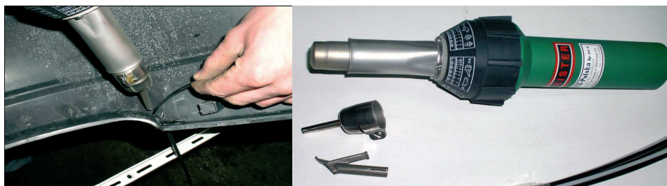
Rys. 6. Spawanie gorącym powietrzem tworzyw sztucznych.
