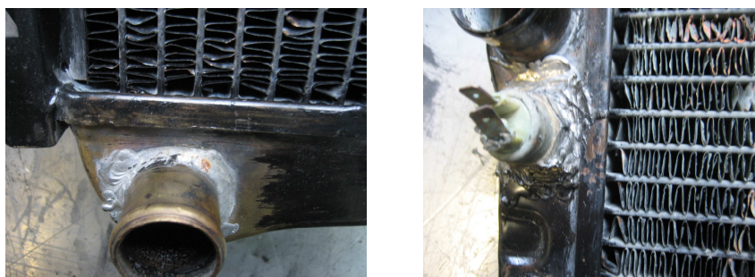
Rys. 10. Naprawa metodą lutospawania: z lewej kruciec wlotowy chłodnicy dużego obiegu układu chłodzenia, z prawej włącznik krańcowy załączający elektryczny wentylator który został wlutowany po zerwaniu gwintu.
