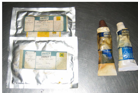
Rys. 4. System opakowań w saszetkach uniemożliwia dozowanie i wielokrotne wykorzystanie składników kompozytu klejowego (bazy i utwardzacza), ponieważ raz otwarte opakowanie ze składnikiem kompozycji powtórnie nie można użyć. Opakowania w tubach lub pojemnikach są dużo bardziej użyteczne i ekonomiczne. Źródło: strona internetowa: http://www.rendor.com.pl/index.php?id=63 (19.10.2009).
