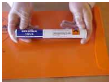
Rys. 3. Kompozyt dwuskładnikowy produkowany w postaci laski, gdzie utwardzacz oddzielony jest od bazy molekularną siatką. Aby użyć taki kompozyt wystarczy odciąć żądaną ilość materiału i wymieszać go jak plastelinę.
