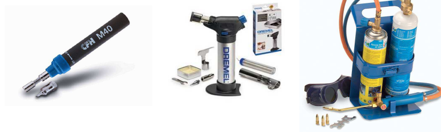
Rys. 9. Urządzenia do lutowania od lewej: mały palnik na (propan-butan) do lutowania niewielkich elementów wykonanych z metali kolorowych, profesjonalny palnik o płomieniu igiełkowym zasilane gazem z butli PB 330-E, zestaw propan-tlen z palnikiem do lutowania twardego aluminium i uszkodzonych dużych powierzchni metali kolorowych.
