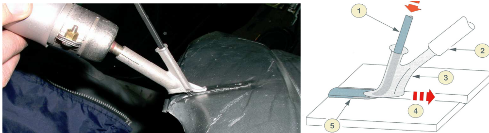
Rys. 7. Szybkie spawanie tworzyw sztucznych (1 - drut spawalniczy, 2 - końcówka dmuchawcy gorącego powietrza, 3 - dysza szybkiego spawania, 4 - kierunek spawania, 5 - spoina).
