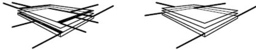
Rys. 4. a) Konstrukcja nakładki rezystancyjnej ośmiodrutowej. b) Konstrukcja nakładki rezystancyjnej pięciodrutowej. Źródło: opracowanie własne.
