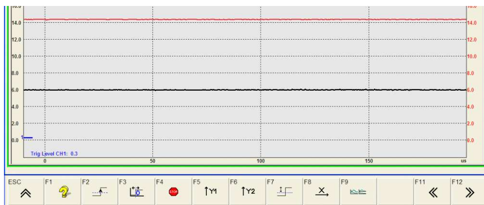
Rys. 9. CAN klasy C. Zwarcie CAN_{Low} do plusa. Diagnostyka KTS 570 firmy Bosch
