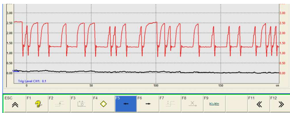
Rys. 10. CAN klasy C. Przerwa w CAN_{High} . Diagnostyka KTS 570 firmy Bosch
