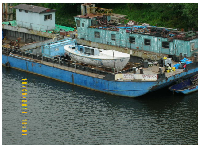
Rycina 10. Inne ujęcie barki przedstawionej na poprzedniej rycinie, gdzie lepiej widoczny jest sposób zamontowania czasowej nadbudówki. Na pierwszym planie dobrze widoczne wnętrza ładowni bargek przedstawionych na rycinach 6 i 7 (Kanał Żeglugowy, Węzeł Wrocławski) Źródło: Fot. autora.
