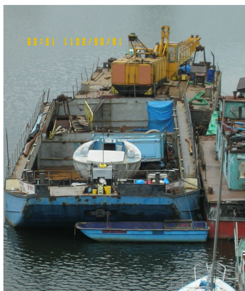
Rycina 6. Barka pchana typu BP 500 wykorzystywana jako jednostka transportowa i warsztatowa. W pierwszej ładowni widoczna transportowana mała jednostka pływająca oraz prawdopodobnie generator prądu na podwoziu kołowym (Kanał Żeglugowy, Węzeł Wrocławski) Źródło: Fot. autora.
