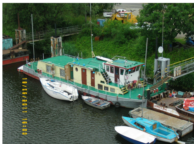
Rycina 8. Pływający ponton (pomiędzy barką a jachtem w prawym rogu) umożliwiający także budowę ruchomych pomostów za- i wylądowczych. Na pierwszym planie pchacz typu „Żubr” (Kanał Żeglugowy, Węzeł Wrocławski) Źródło: Fot. autora.
