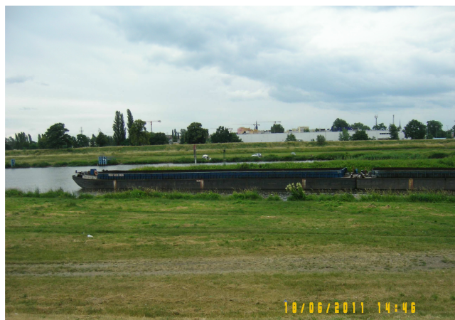
Rycina 4. Barka pchana typu BP 500 przeznaczona do transportu ładunków masowych. Doskonale widoczne są zrębnice (pomalowane na kolor niebieski) wzmocnione mocnikami (Kanał Żeglugowy, Węzeł Wrocławski) Źródło: Fot. autora.
