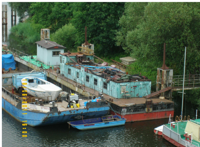
Rycina 9. Barka pchana BP 500 pełniąca rolę hulki mieszkalnego (Kanał Żeglugowy, Węzeł Wrocławski) Źródło: Fot. autora.
