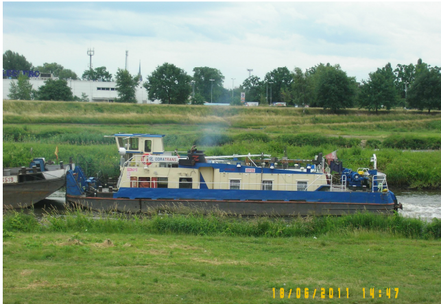
Rycina 5. Pchacz typu „Bizon” pchający barkę pchaną typu BP 500 przeznaczoną do transportu ładunków masowych. Doskonale widoczny jest sposób połączenia pchacza z barką pchaną (Kanał Żeglugowy, Węzeł Wrocławski) Źródło: Fot. autora.
