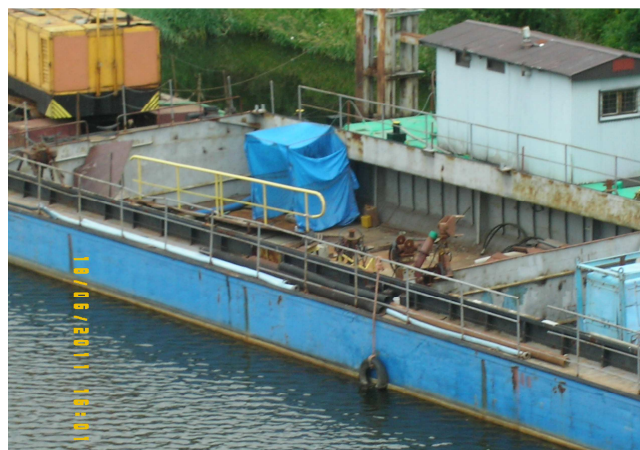
Rycina 7. Przednia ładownia barki przedstawionej na rycinie 6. Dobrze widoczny jest osprzęt specjalistyczny (jak urządzenia spawalnicze) oraz ochrona przed niesprzyjającymi warunkami atmosferycznymi (Kanał Żeglugowy, Węzeł Wrocławski) Źródło: Fot. autora.
