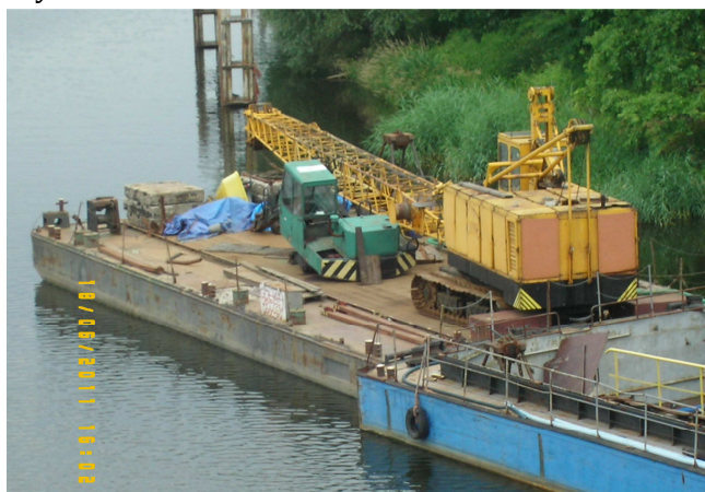
Rycina 3. Barka pchana przeznaczona do transportu pojazdów. Uwagę zwraca rozmieszczenie urządzeń cumowniczych, przez co możliwy jest załadunek zarówno od strony dziobu, jak i z burty (Kanał Żeglugowy, Węzeł Wrocławski) Źródło: Fot. autora.
