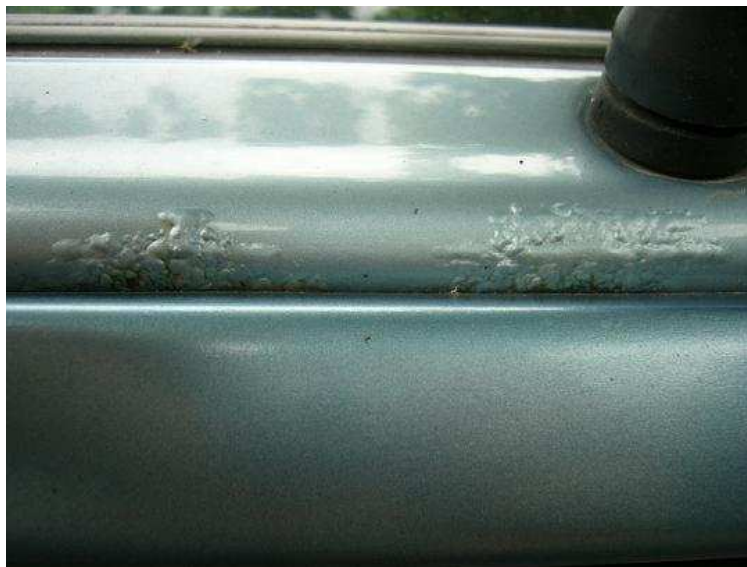
Rys. 6. Pęcherzenie powłoki lakierniczej nadwozia samochodu w wyniku rozwoju korozji podpowłokowej [19]
