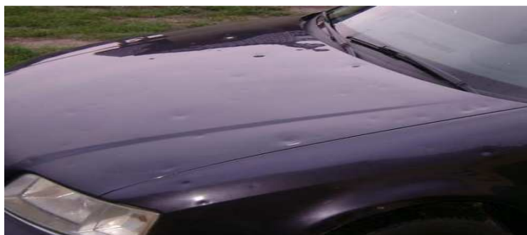
Rys. 11. Erozyjne zużycie powłoki lakierniczej nadwozia samochodu w wyniku uderzeń gradu [13]
