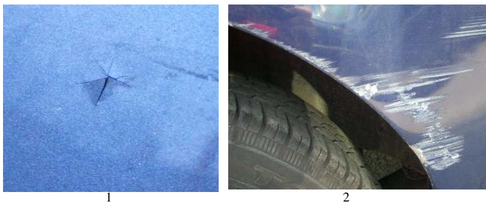
Rys.10. Pęknięcie i odwarstwienie powłoki lakierniczej nadwozia samochodu pod wpływem uderzenia kamienia (1) [19] oraz zarysowanie powłoki [13]
