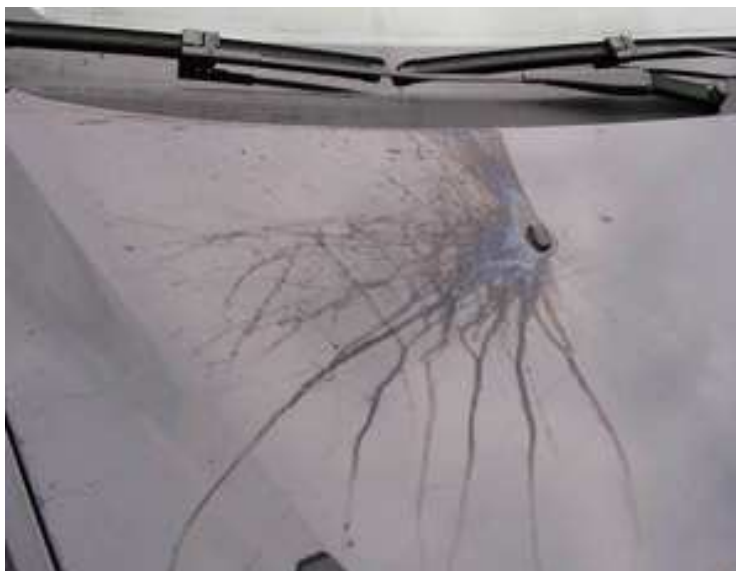
Rys.7. Plama powstała na powłoce lakierniczej nadwozia samochodu pod wpływem płynu do spryskiwania szyb [18]
