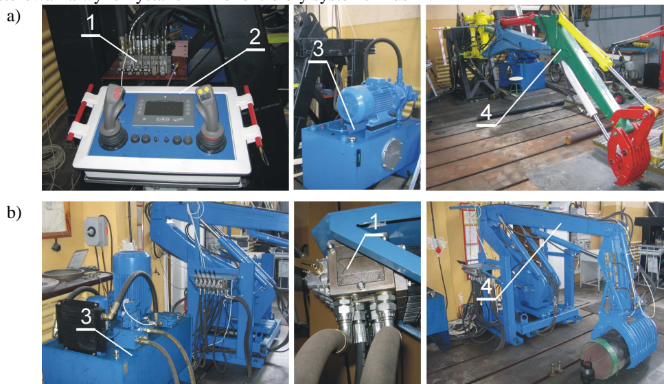
Rys.1. Stanowiska badawcze do testowania kinematyki osprzętów roboczych w misjach EOD/IED: 1 – rozdzielacz hydrauliczny z elektronicznymi modułami CAN-bus, 2 – pulpit zdalnego sterowania, 3 – agregat hydrauliczny, 4 – osprzęt roboczy
