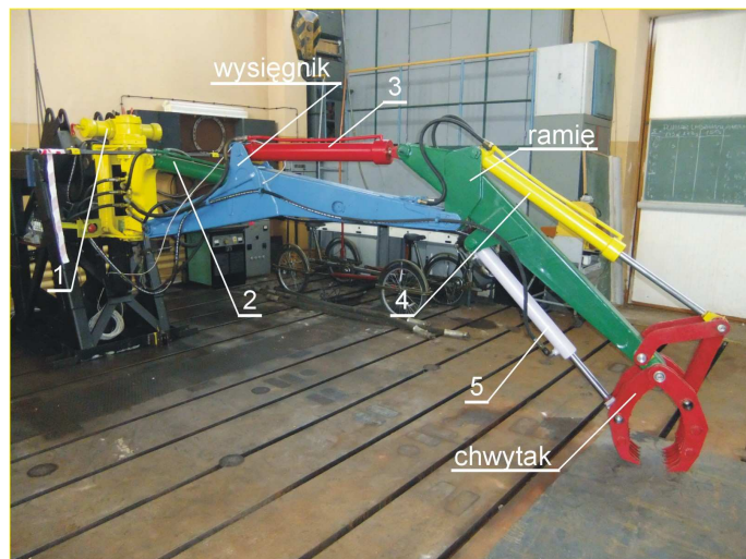
Rys.3. Zaadoptowany do misji EOD/IED osprzęt roboczy koparki K-161: 1 – siłownik obrotu osprzętu, 2 – siłownik wysięgnika, 3 – siłownik ramienia, 4 – siłownik górnej szczęki chwytaka (łyżki), 5 – siłownik dolnej szczęki chwytaka
