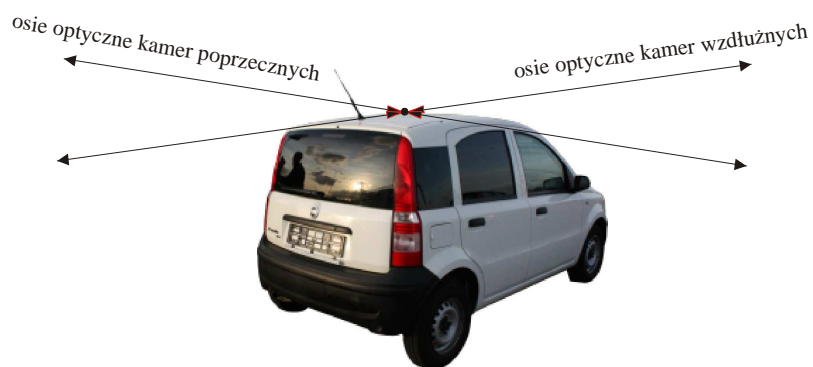
Rys.3. Pierwotne rozmieszczenie kamer podsystemu wizyjnego
