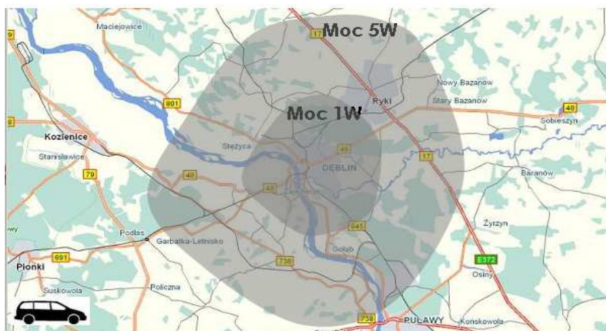
Rys. 8. Zasięg transmisji danych w relacji samochód - stacja naziemna, moc 1 i 5 W
