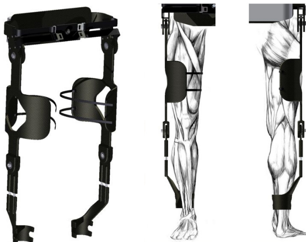
Rys. 1. Układ wspomagania chodu – projekt szkieletu mechanicznego
