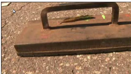
Drag sled, wycinek opony + siłomierz
