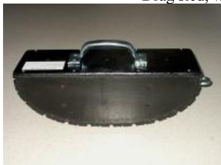
Drag sled, wycinek opony + siłomierz
