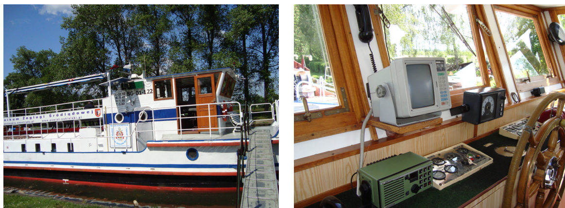
Rys.1. Wyposażenie mostka nawigacyjnego na jednostce morsko-rzecznej m/s „Władysław Łokietek”. Zdjęcia zrobione dn. 29.05.2009 podczas Konferencji Inland Shipping 2009 w Nakle nad Notecią [21]
