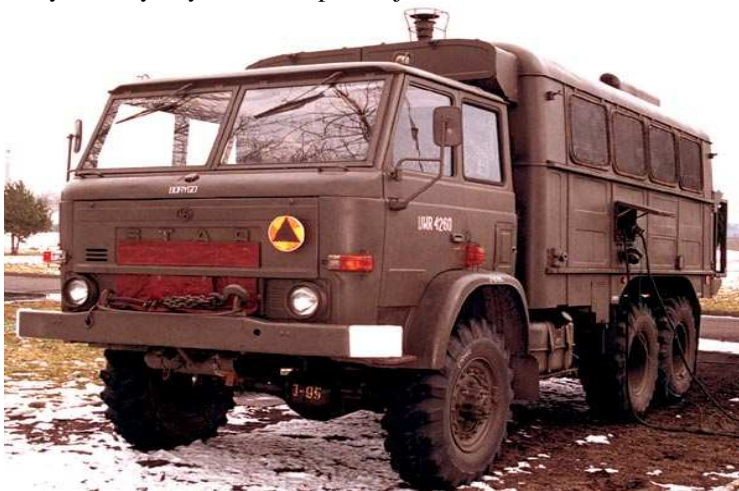
Rys. 1. Star 266 z nadwoziem warsztatowym typu SARNA I (typ 550)
