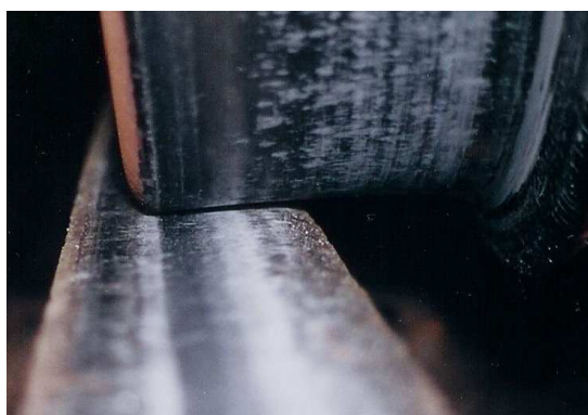
Rys.2. Przykładowe położenie koła w stosunku do szyny
