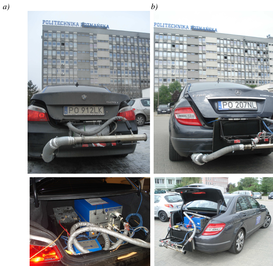
Rys. 5. Pojazdy wykorzystywane do badań wraz z zamontowaną aparaturą pomiarową
