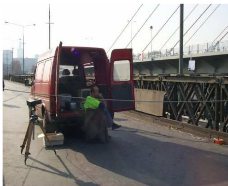
Rys.5. Zastosowanie metody wizyjno-komputerowej do badań dynamicznych konstrukcji mostowych: a) badania mostu Świętokrzyskiego w Warszawie, b) dwukanałowy układ optyczny [8]
