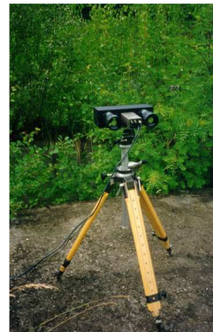
Rys.5. Zastosowanie metody wizyjno-komputerowej do badań dynamicznych konstrukcji mostowych: a) badania mostu Świętokrzyskiego w Warszawie, b) dwukanałowy układ optyczny [8]
