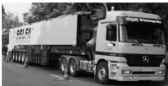
Rys.2. Pojazd BELFA w pozycji transportowej
