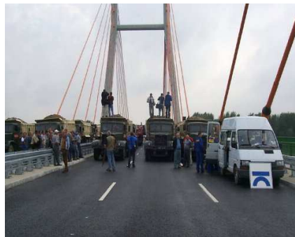
Rys.4. Próbné obciążenie mostu Siekierkowskiego w Warszawie
