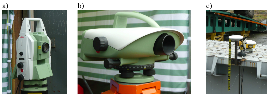
Rys.11. Elementy systemu pomiarowego GNSS: a) tachimetr robotyczny Leica TM30, b) Niwelator kodowy Leica sprinter 220, c) odbiorniki GNSS Trimble SPS i 5700
