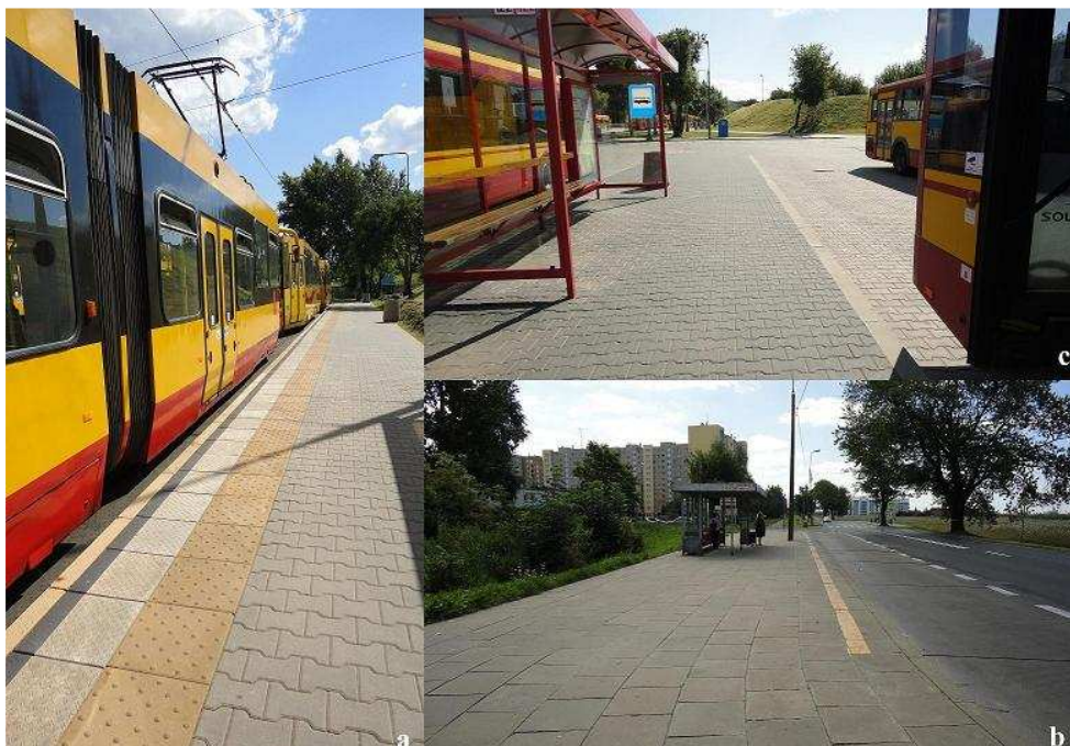
Rys. 5.4 Rodzaje oznaczenia krawędzi peronu: a). oznaczenie prawidłowe wizualne i dotykowe; b). oznaczenie tylko wizualne; c). brak oznaczenia krawędzi peronu
