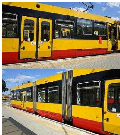
Rys. 5.2 Tramwaj wieloczołowy - oznaczenie boczne numeru linii tylko przy drzwiach przednich, głośnik zewnętrzny nieaktywny
