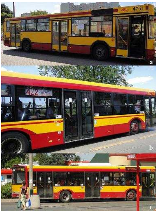
Rys. 5.1 Przykładowe oznaczenie boczne autobusu (numer linii) stosowane w MZA Warszawa: a). oznaczenie numeru linii przy drzwiach środkowych (strona prawa), brak przycisków do otwierania drzwi; b). oznaczenie numeru linii przy drzwiach środkowych (strona lewa), przycisk do otwierania drzwi - strona lewa; c). oznaczenie numeru linii na krawędzi dachu przy drzwiach przednich (strona lewa) – nieczytelne, przyciski do otwierania drzwi po obu stronach
