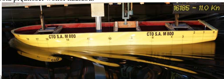
Rys.9 Przykład przeprowadzania badań modelowych na modelu M800
