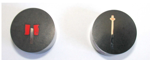
Rys. 1. Spawanie laserowe. Próbka lewa – elektroda boczna, próbka prawa – elektroda środkowa
