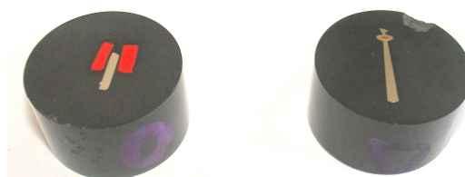
Rys. 2. Zgrzewanie oporowe. Próbka lewa – elektroda boczna, próbka prawa – elektroda środkowa
