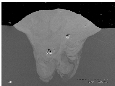
Rys. 3. Spawanie laserowe – elektroda boczna. Powiększenie 70x.
