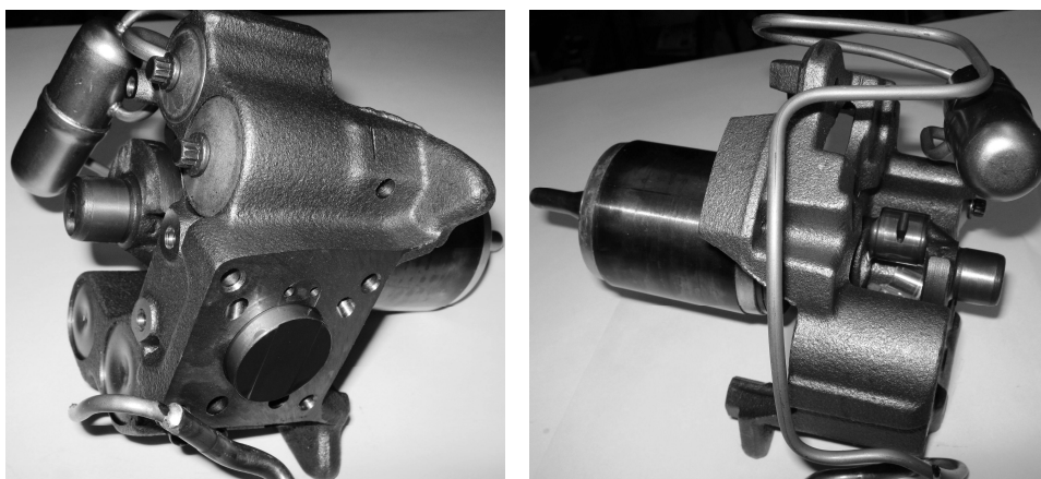
Rys. 3. Węzły ruchowe sprężarki tłokowej Embraco Aspera NE9213GK
