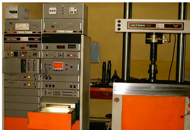
Rys.5. Maszyna wytrzymałościowa statyczno-dynamiczna typu Instron 1273
