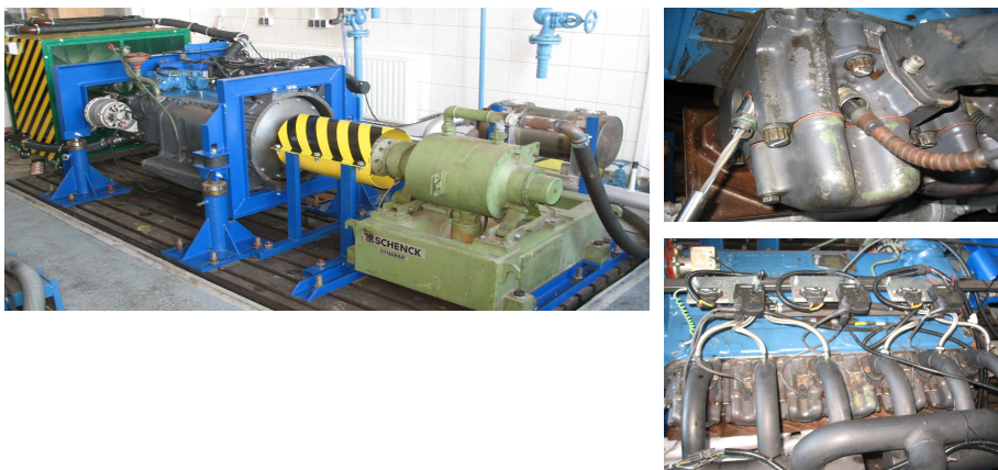
Rys.4. Stanowisko do badań hamownianych silnika oraz głowica silnika zaadaptowana do pomiarów ciśnienia w komorze spalania i elementy układu zapłonowego zamontowane na silniku OM 427CNG-I
