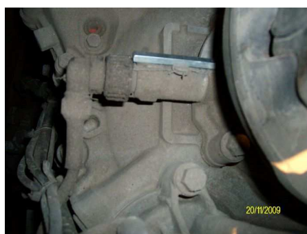
Rys. 7. Zdjęcie przedstawia zainstalowany magnes na impulsatorze
