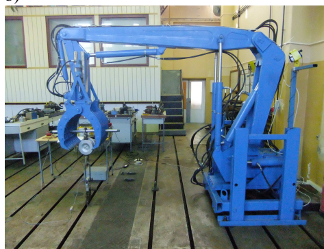
Rys. 3. Przykładowe konfiguracje manipulatora dla wsięgu 2100 mm
