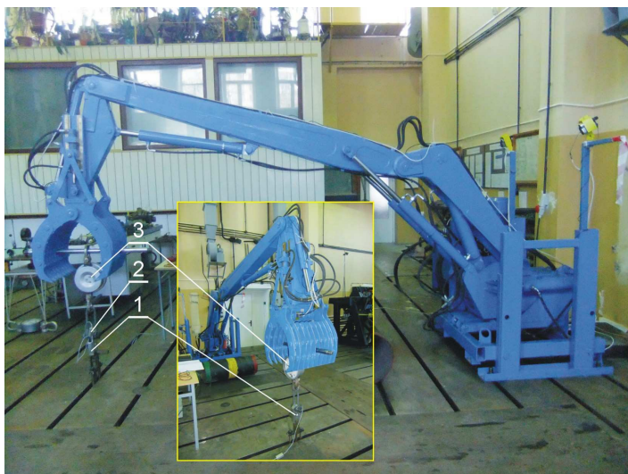
Rys.1. Stanowisko badawcze do pomiaru siły udźwigu manipulatora robota wsparcia inżynierskiego (opis w tekście)
