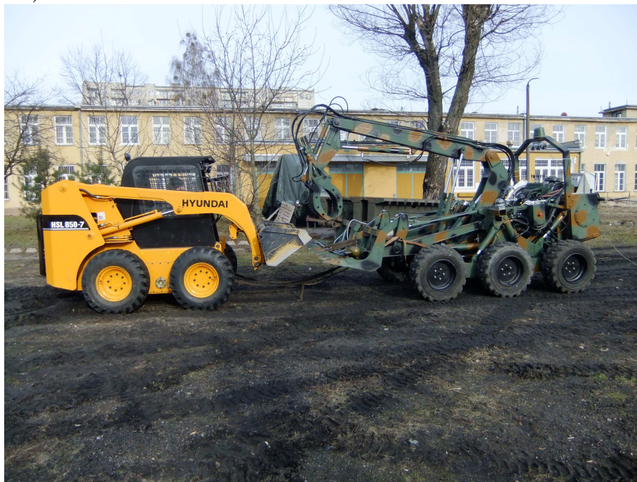
Rys.10. Próba holowania pojazdu kołowego o masie ok. 3000 kg przed robotem
