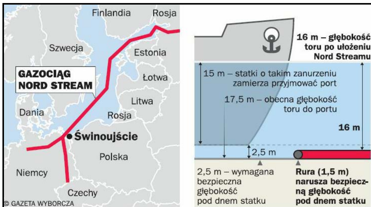
Rys. 6. Parametry toru podejściowego w świetle ułożenia gazociągu
