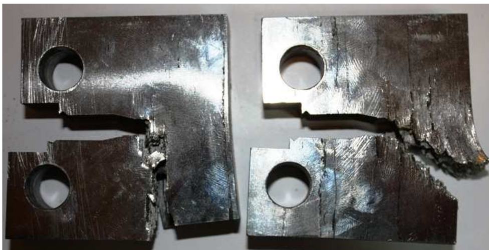
Rys. 5. Próbki zwarte po badaniach odporności na pękanie (materiał A1) i anormalna trajektoria pęknięcia. Na próbkach widoczne rozległe pasma wtrąceń niemetalicznych powodujących pękanie próbek wzdłuż ich rozkładu.
