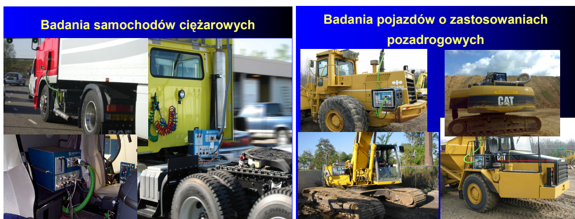
Rys. 4. Badania emisyjności pojazdów ciężarowych i pozadrogowych z wykorzystaniem mobilnego systemu analizatorów Semtech DS
