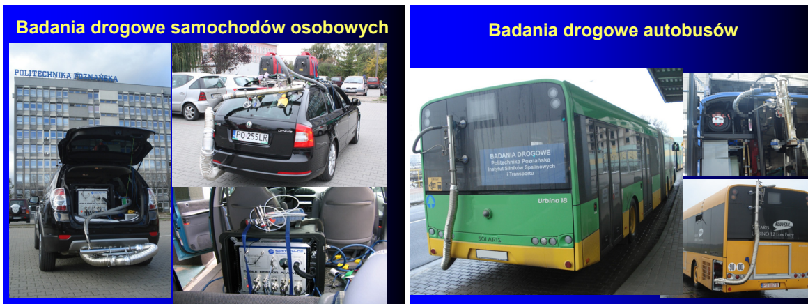
Rys. 3. Wykorzystanie mobilnego systemu pomiaru emisji spalin w pojazdach osobowych i autobusach
