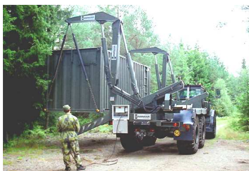
Rys. 2. Rozładunek kontenera za pomocą urządzenia boczego załadunku na terenowym pojeździe kołowym
