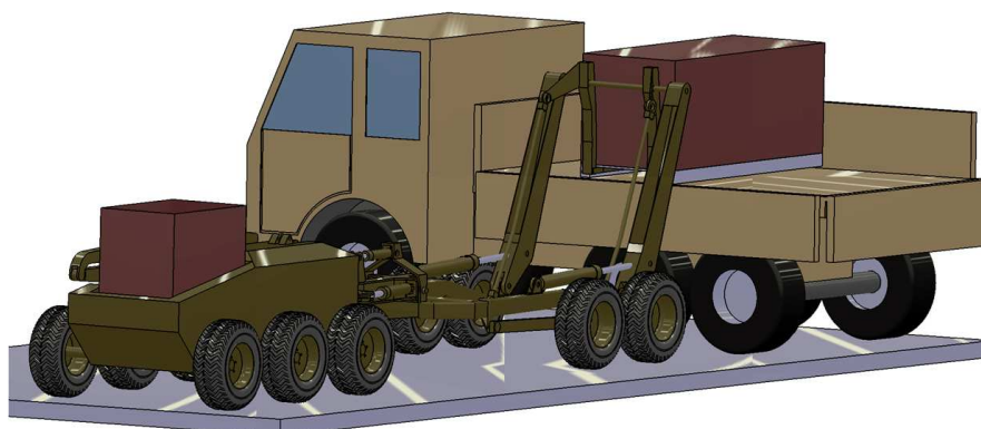
Rys. 5. Podejmowanie ładunku osprzętem widłowym tylnego członu IRWT „Bogus” z przestrzeni transportowej samochodu ciężarowego
