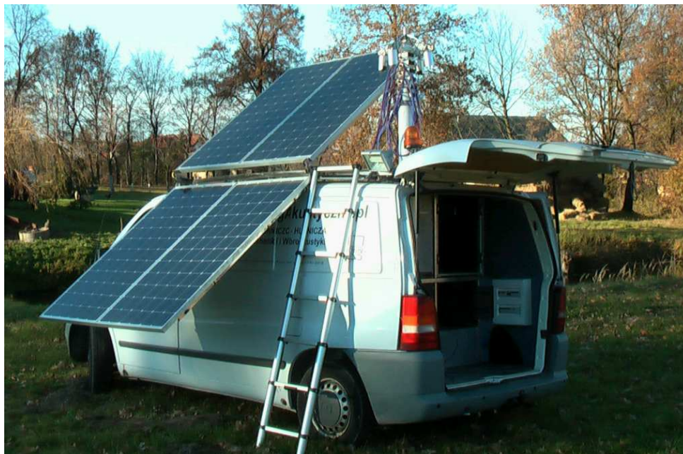
Rys. 4. Prototyp mobilnej stacji multimedialnego monitoringu środowiska
