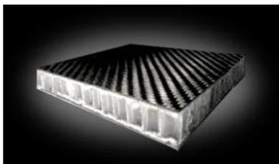
Rys.1. Struktura przekładkowa typu „sandwich” z rdzeniem w kształcie plastra miodu[8].
