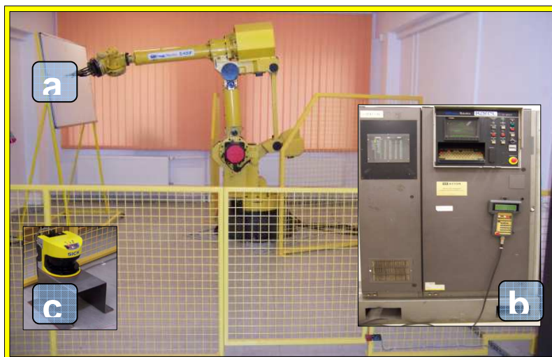
Rys. 1. 1. Zintegrowany Zrobotyzowany System a) Stanowisko robocze; b) Kontroler R-H, Teach Pendant; c) Skaner SICK S3000, (Laboratorium Zakładu Automatykacji Procesów na Wydziale Transportu i Elektrotechniki Politechniki Radomskiej)
