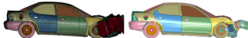
Rys.8. Wynik symulacji po zderzeniu
