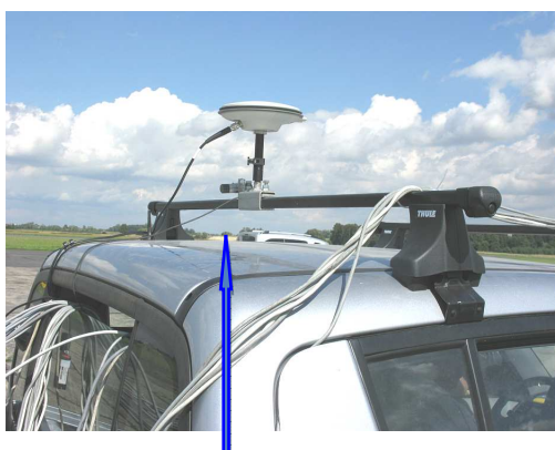
Rys. 4. Dodatkowa opcja mocowania kamery HD do relingu dachowego w miejscu mocowania drugiej anteny GPS współpracującej z żyrokompasami i referencyjnym sygnałem korekcji błędu pozycji (dokładność 0,5cm)
