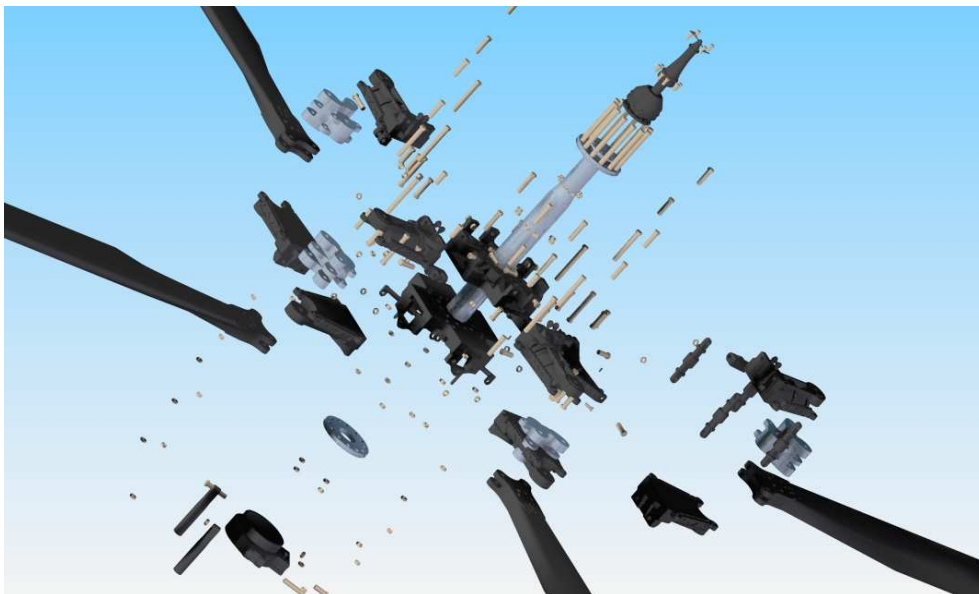
Rys. 15. Rozstrzezenie w programie Solid Edge zespołu śmigła głównego w skład którego wchodzi 246 części
