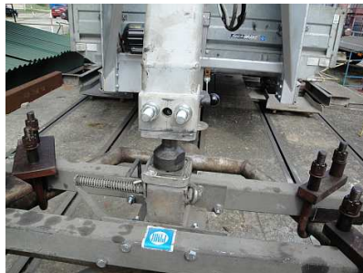
Rys. 2. Widok wspornika zaczepu kulowego zamocowanego na ramie kotwiącej i sprzęgniętej z nim naczepy GN2000
