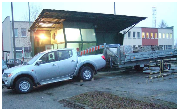
Rys. 1. Badania kontrolne na stanowisku podwoziowym prawidłowości montażu wspornika zaczepu kulowego w samochodzie Mitsubishi L200
