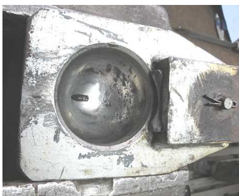
Rys. 5. Sprzęg ze stali S355 – wyraźne ślady zużycia powierzchni gniazda (czaszki), z lewej strony podłużne wgłębienie jest rowkiem połączonym ze smarowniczką
