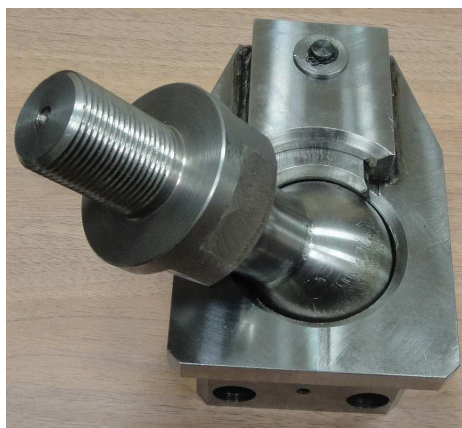
Rys. 6. Widok nowego kompletu sprzęgu kulowego i zaczepu kulowego dla naczep typu gęsia szyja kategorii O2 i O3
