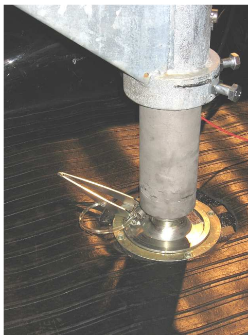
Rys. 8. Sprzęg kulowy stosowany w Holandii dla naczep kategorii O2 i O3
