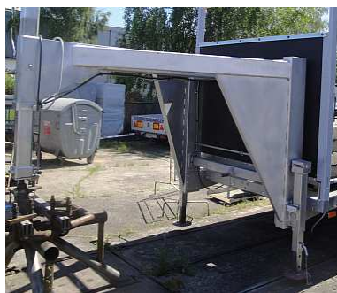
Rys. 3. Dyszel naczepy PIMR-N-O3 ze sprzęgiem kulowym zamocowanym na zaczepie kulowym umocowanym we wsporniku samochodu Lublin i ramie wsporczej
