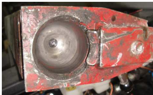
Rys. 4. Sprzęg naczepy GN2000 z ulepszonej stali 40H, po 10-letnim okresie eksploatacji
