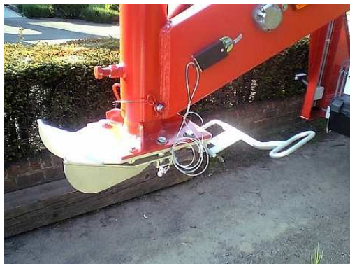
Rys. 7. Sprzęg kulowy stosowany w Belgii dla naczep kategorii O2, z elektrycznymi hamulcami (elektromagnesy) z USA
