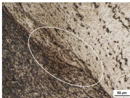
Rys. 13. Widok strefy połączenia nakrętki ze śrubą. Widoczny wzrost tarciový śruby z nakrętką.
