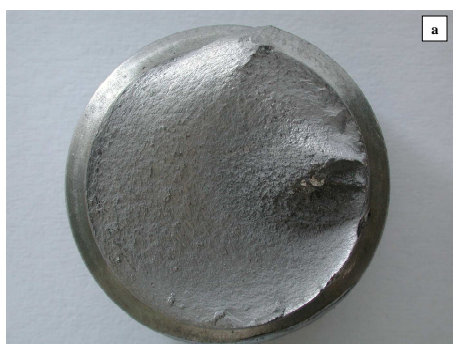
Rys. 3. Próbkę metalograficzną pękniętej śruby „1” a) zdjęcie makroprzełomu;
