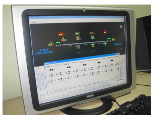
Rys. 6. Wygląd symulatora blokady SHL-12 zaprojektowanego pod potrzeby laboratorium
