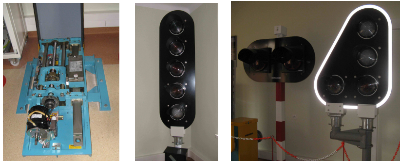
Rys. 11. Widok wybranych urządzeń srk (napęd zwrotnicowy typu EAA-5, sygnalizator 5-komorowy typu EHA-22, sygnalizator drogowy typu EHZ-7, sygnalizator ostrzegawczy maszynisty typu EHZ-5) badanych w Laboratorium Systemów SRK
