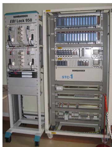
Rys. 4. Zestawienie stanowiska dyżurnego ruchu z systemem EbiScreen oraz zabudowa systemu nastawczego EbiLock 950 wraz ze stojakiem sterowników obiektowych STC
