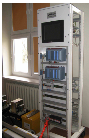
Rys. 10. Widok całości stanowiska licznikowego systemu stwierdzania niezajętości odcinków torowych typu SOL-21 z aparaturą sterującą i monitorem dotykowym[9]
