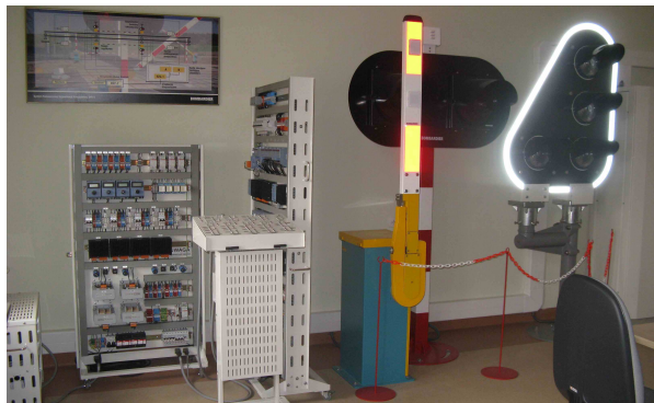
Rys. 8. Widok ogólny stanowiska samoczynnej sygnalizacji przejazdowej typu SPA-5 produkcji Bombardier Transportation (ZWUS) Polska [9]
