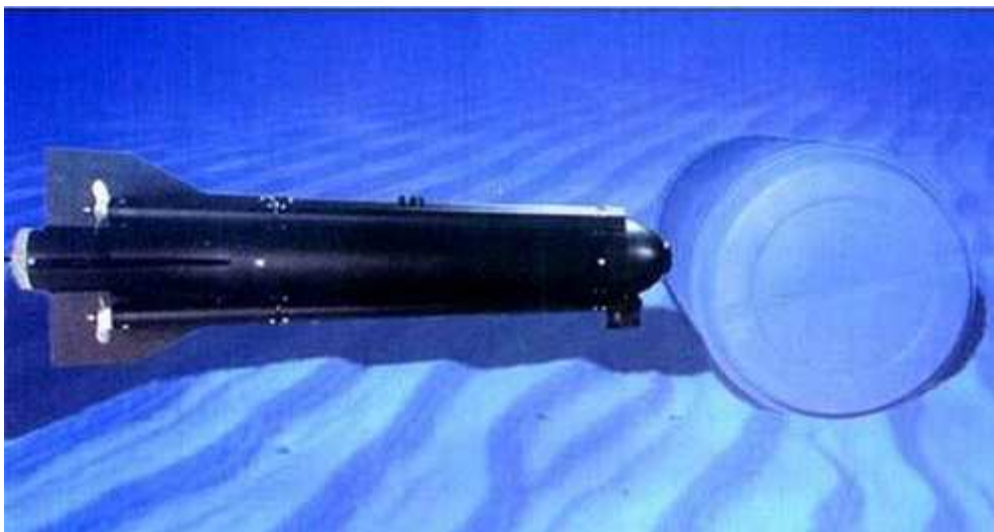
Rys.2. Pojazd jednorazowego użytku typu SeaFox w pozycji do neutralizacji miny dennej. Źródło http://www.royalnavy.mod.uk
