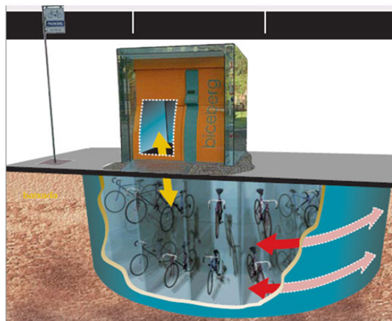
Rys. 4. Projekt parkingu dla rowerów „Bike Tree” firmy Bahrain and India Design i urządzenie parkingowe Biceberg (prawy rysunek)
