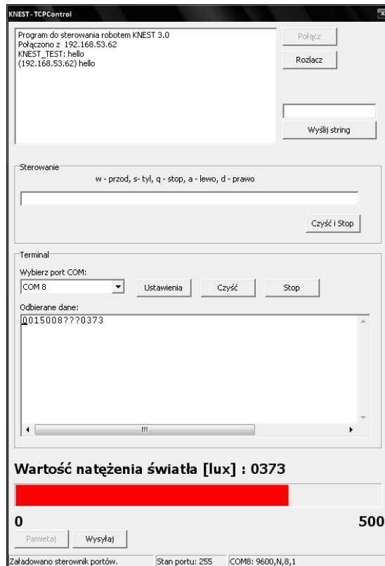
Rys.7. Przykładowa prezentacja danych po połączeniu z klientem - prezentacja natężenia oświetlenia w przypadku przekroczenia ustalonej wcześniej granicy (w tym przypadku 300 lx)
