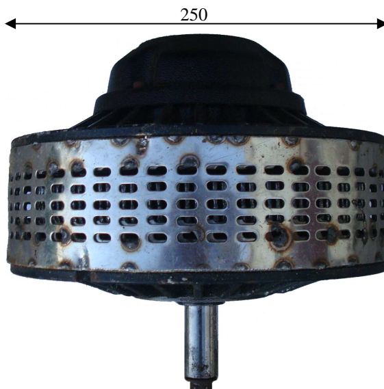
Rys.1. Silnik prądu stałego (14kW, szczyt 30kW, 84V, waga 11kg) firmy LEMCO D-135 przeznaczony do napędu w samochodzie elektrycznym
