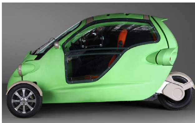
Rys.11. Trójkołowy dwuosobowy pojazd elektryczny Re-Volt firmy Impact Automotive Technologies
