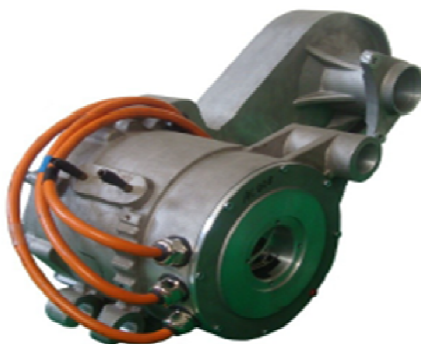
Rys.12. Blok napędowy pojazdu Re-Volt napędzający tylną oś
