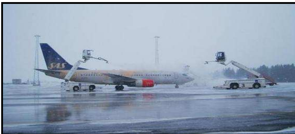
Rys. 2. Boeing 737 linii lotniczych SAS podczas odladzania i zabezpieczenia na przeznaczony do tego płycie w porcie lotniczym w Trelleborgu w Szwecji. [9]
