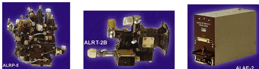
Rys. 2. Elementy głównego układu paliwowo-regulacyjnego
