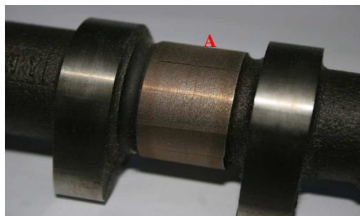
Rys. 6. Widok wałka rozrządu silnika Subaru BOXER 2,5 DOHC z czopami teksturowanymi laserowo: a) widok wału rozrządu po teksturowaniu, b) widok fragmentu wału rozrządu z czopem teksturowanym laserowo (mikrozasobniki olejowe w kształcie czasz); A – mikroczasze, B – mikrokanaty
