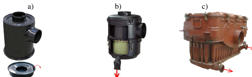
Rys. 7. Usuwanie pyłu z osadników filtrów powietrza: a) samochodu Jelcz 317, b) Mann-Hummel [11], c) czołgu T-72
