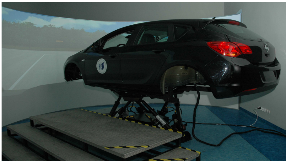
Rys. 2. Symulator samochodu osobowego, znajdujący się w ITS
