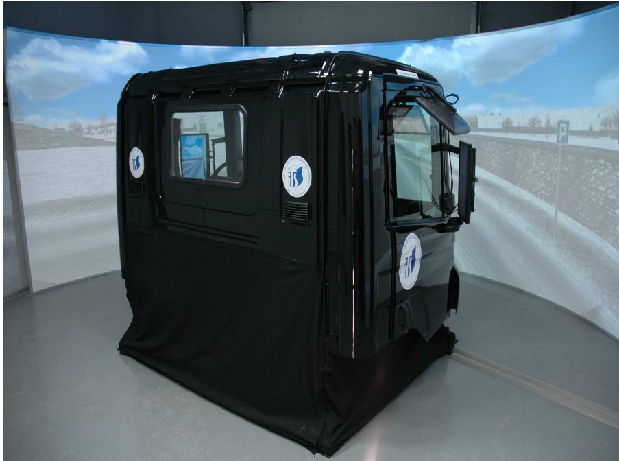
Rys. 3. Symulator samochodu ciężarowego i autobusu znajdujący się w ITS
